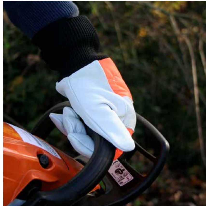
Handen onjuist geplaatst
